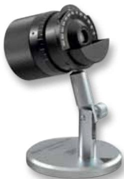
Модель глаза, идеальная для обучения и практики. Точная установка размера зрачка и ошибки рефракции и, следовательно, возможность их повторения. Две контрольные линзы в корпусе. Градуированная шкала для определения цилиндров.
