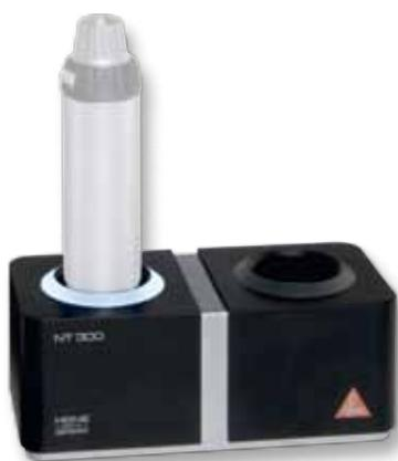
Габариты: ширина 142 мм, высота 61 мм, глубина 66 мм. Вес 830 г. Зарядный блок NT 300 автоматически заряжает перезаряжаемые аккумуляторы HEINE независимо от состояния заряда аккумулятора или их выходного вольтажа. Предусмотрена защита от перезарядки. С помощью подходящего адаптера в NT 300 можно заряжать любые перезаряжаемые рукоятки BETA L, BETA NT, BETA SLIM и все ларингоскопические перезаряжаемые рукоятки. Исключение составляют перезаряжаемые рукоятки Short F.O. LED и Small F.O. LED.
